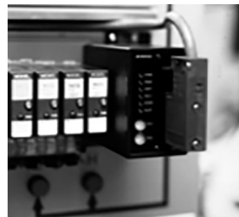
図 1 リモート I/O スーパーフレックス M9 シリーズ PROFIBUS 用
