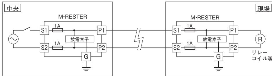
万一サージ吸収素子が短絡したときにヒューズが切れるように給電側にS1・S2端子がくるように配線して下さい。
