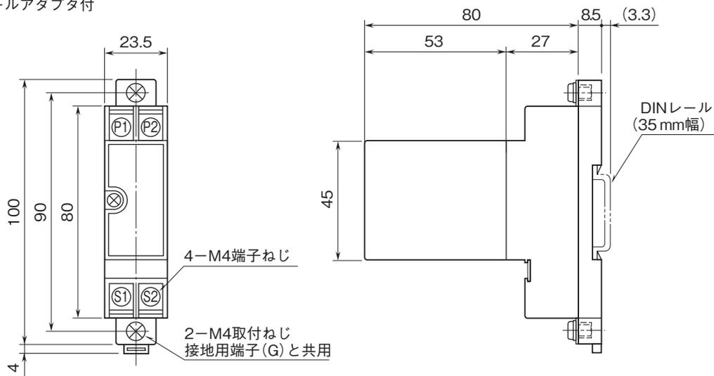
取付寸法図(単位:mm)
