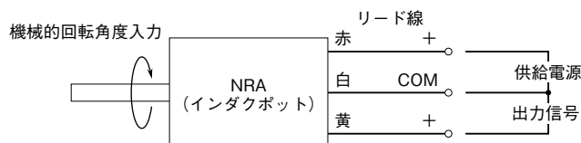
図4 インダクポット結線図
