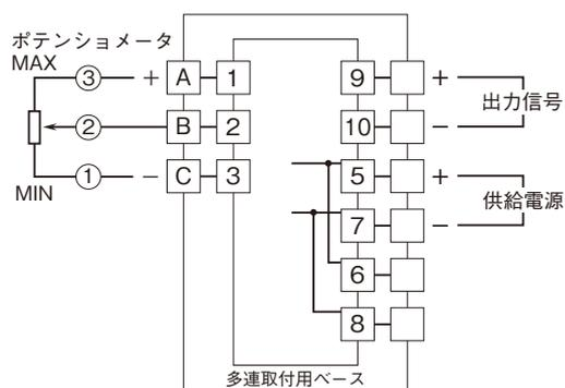
注) 入出力の信号配線には、シールドケーブルを使用して下さい。
