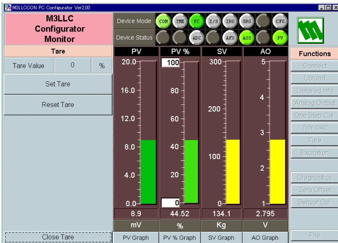
“Tare Value” に、現在の風袋調整値が%値で表示されます。風袋調整がなされていない状態では、風袋調整値は0%です。入力のワンステップ校正や入力のレンジ変更がなされると、風袋調整値は自動的に0%にリセットされます。
