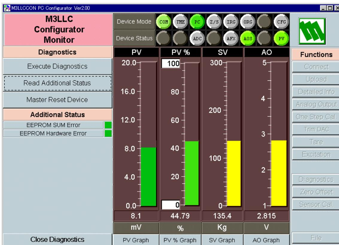
“Execute Diagnostics” ボタンを用いて、デバイスの診断を行うことができます。診断の結果は Additional Status 表示欄に表示されます。Additional Status 表示欄では、デバイスの Additional Status の各項目とその内容(状態)が表示されます。正常時は緑色表示で、異常時は赤色表示です。
