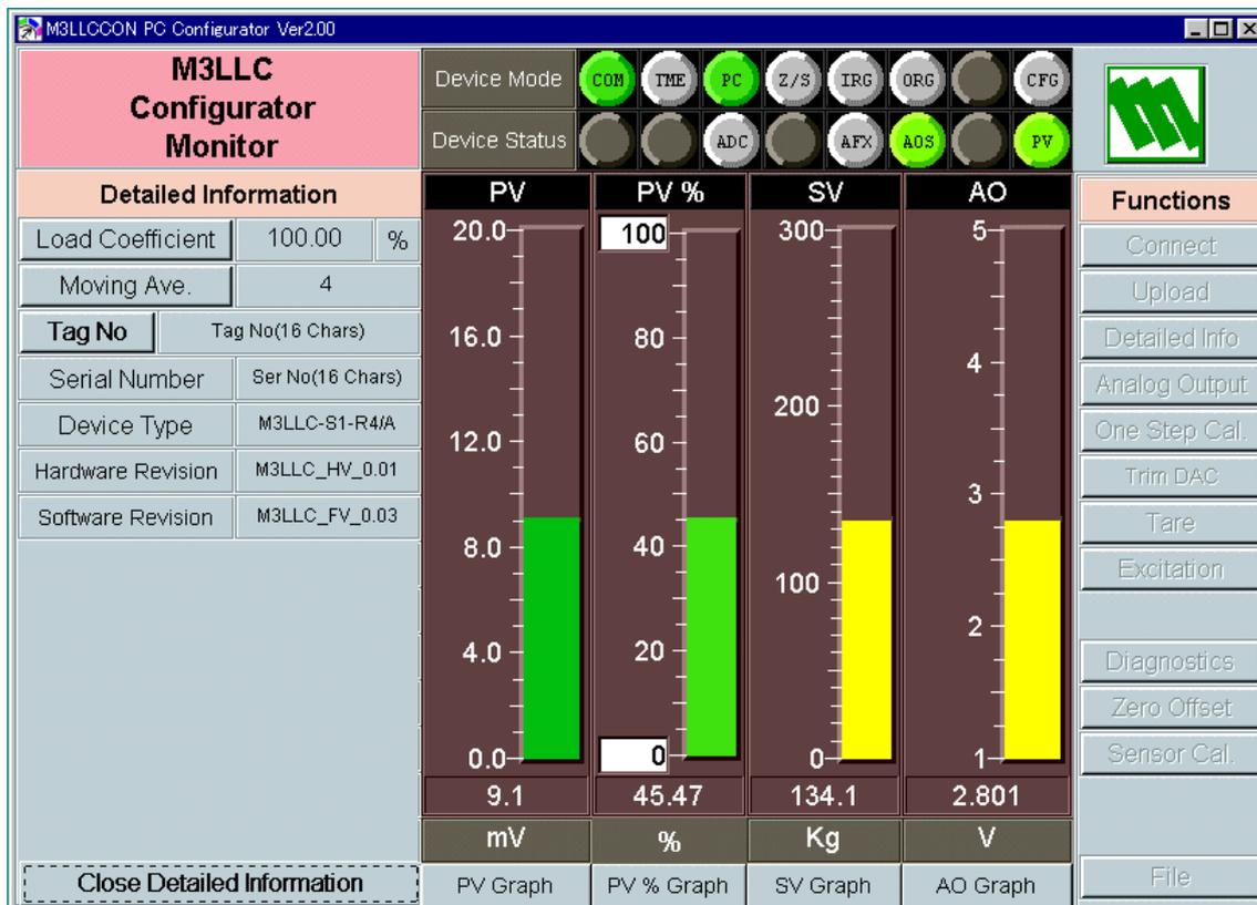
“ Load Coefficient ” では、負荷係数を%値で表示します。“ Load Coefficient ” ボタンで変更ができます。負荷係数は、ワンステップ校正における、100%のスケール値校正時に用いられます。負荷係数が 100%値時には、100%のスケール値を校正する場合、対応する実際の負荷（重さ）をかける必要があります。一方、たとえば負荷係数が 10%時には、100%のスケール値を校正する場合、対応する実際の負荷（重さ）の 1/10 の負荷（錘）をかけることで、校正できます。設定範囲は、10%から 100%の値です。
