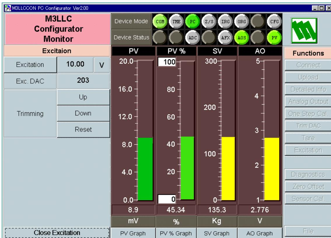
“Excitation”には、印加電圧の設定値が表示されます。“Excitation”ボタンを押すと、印加電圧設定値を変更することができます。DIP モードの場合は、印加電圧はロータリースイッチと SW3 スイッチで決定されますので、この画面では設定変更できません。印加電圧の変更は、それらのスイッチで行ってください。設定内容は画面に自動反映されます。
