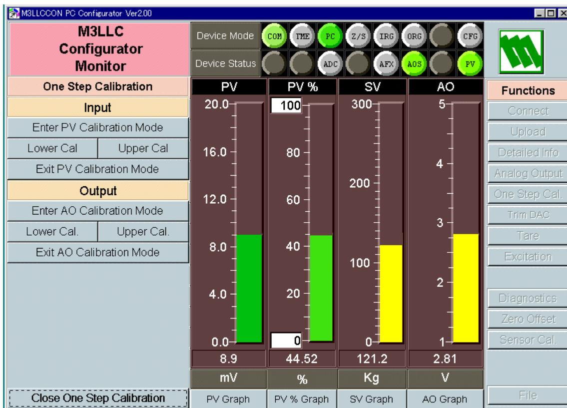
入力のワンステップ校正を行うには、“ Enter PV Calibration Mode ” をクリックし、入力ワンステップ校正モードにします。入力ワンステップ校正モードになると“ Device Mode ”の“ IRG ”ランプが赤色点灯します。0%または100%の入力値を印加し、対応する“ Lower Cal ”または“ Upper Cal ”を押すと、自動的に入力のスケールの値が決定されます。M3LLCの場合、“ Lower Cal ”で自動的に入力のゼロオフセット調整を行いますので、“ Lower Cal ”を行った後には必ず“ Upper Cal ”を行ってください。校正が終了したなら“ Exit PV Calibration Mode ”を押して、校正モードを解消してください。
