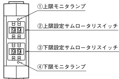
各モニタランプはそれぞれ上限、下限警報用リレーが励磁状態のとき点灯します。
