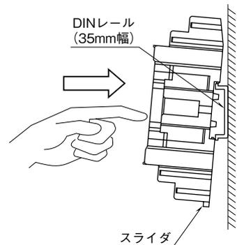
取外す場合はマイナストライバなどでスライダを下に押し下げその状態で下側から引いて下さい。
