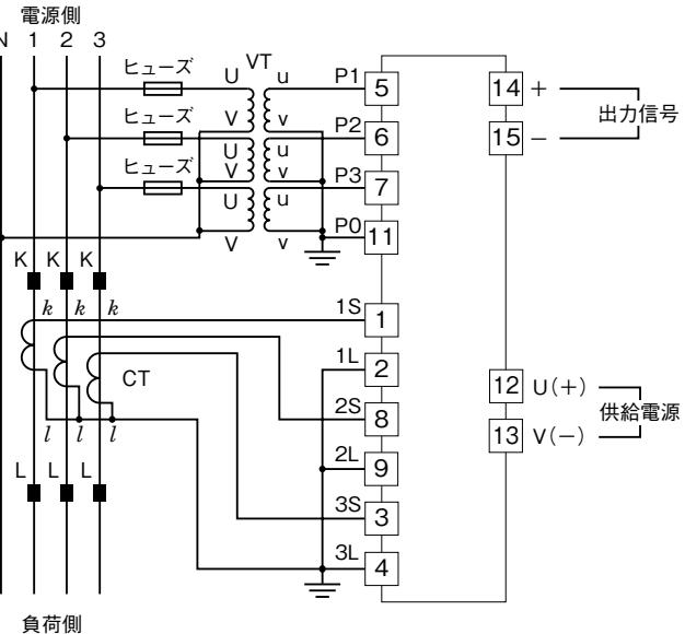
※、入力電圧回路の電圧が比較的安定しており、供給電源の仕様を満足する場合には、入力電圧回路から供給することも可能です。
