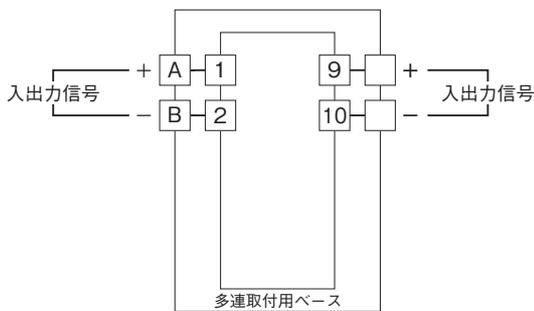
注) 入出力の信号配線には、シールドケーブルを使用して下さい。
