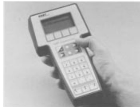
그림 1 HART 커뮤니케이터 (HCF에서 발행한 HART LINE)
