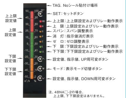
図2 48ND□、48NA□の前面パネル図
