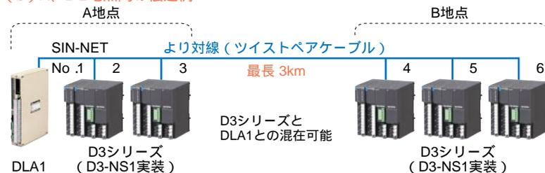
図2 多重伝送システム構成例
