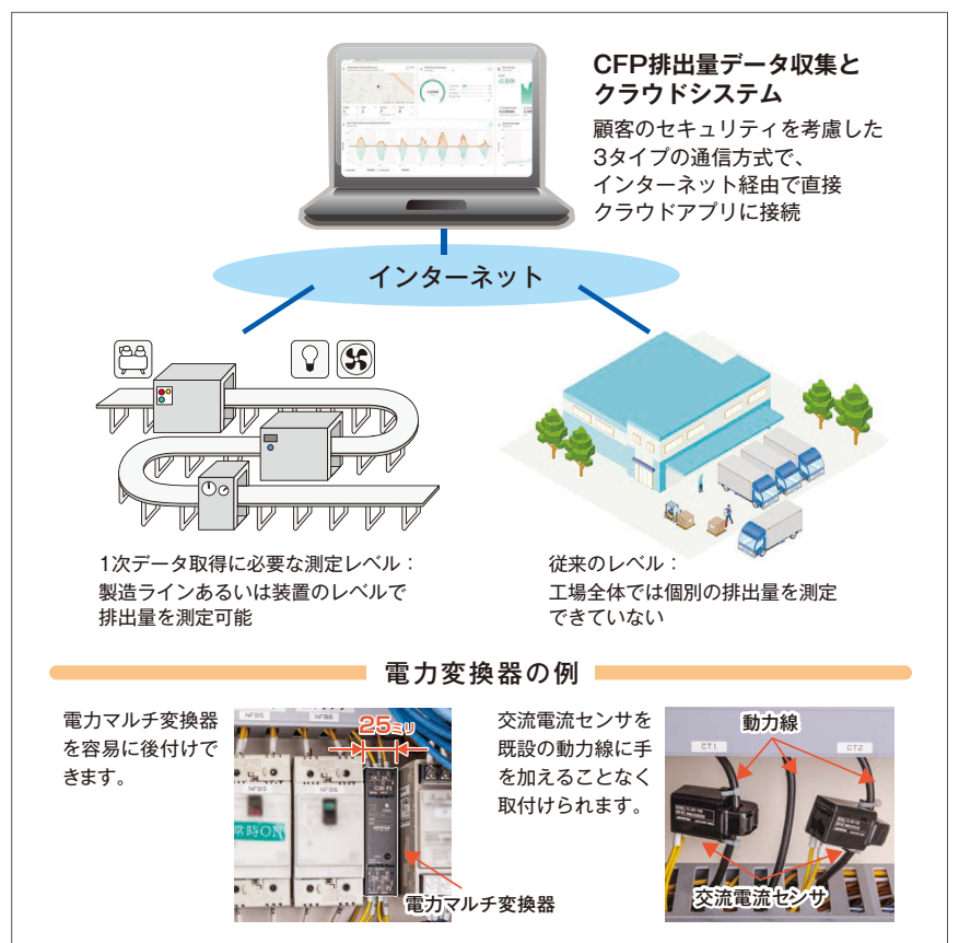
図4 CFP 1次データ取得システムと製品の構成例
