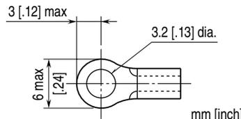
■ EURO TYPE CONNECTOR TERMINAL (Power input, Modbus)
