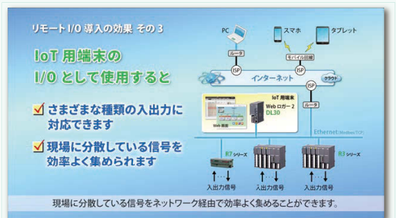
IoT 端末としてのリモートI/O
