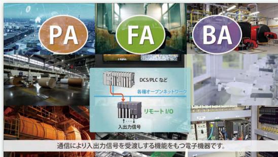
通信による入出力信号の受け渡し
