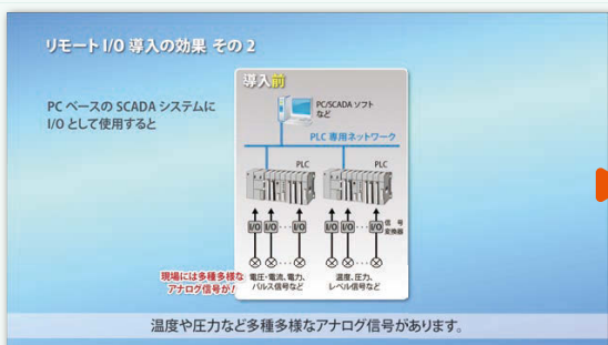
リモートI/O導入前の現場計器
