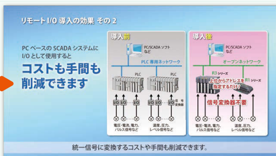
リモートI/O導入後の現場計器
