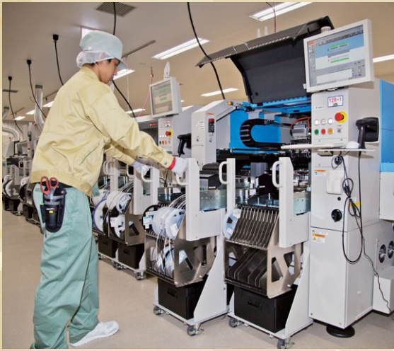
チップマウンタを使用した エム・システム技研の製造ライン
