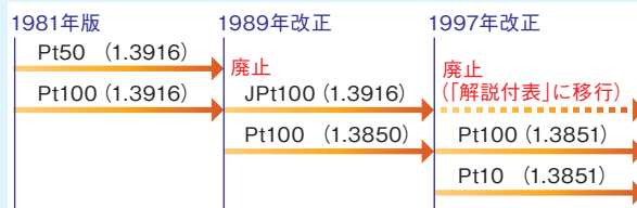
図1 JIS C1604 測温抵抗体の変遷 ( ( )内数値は、 R_{100}/R_0 を示す)
